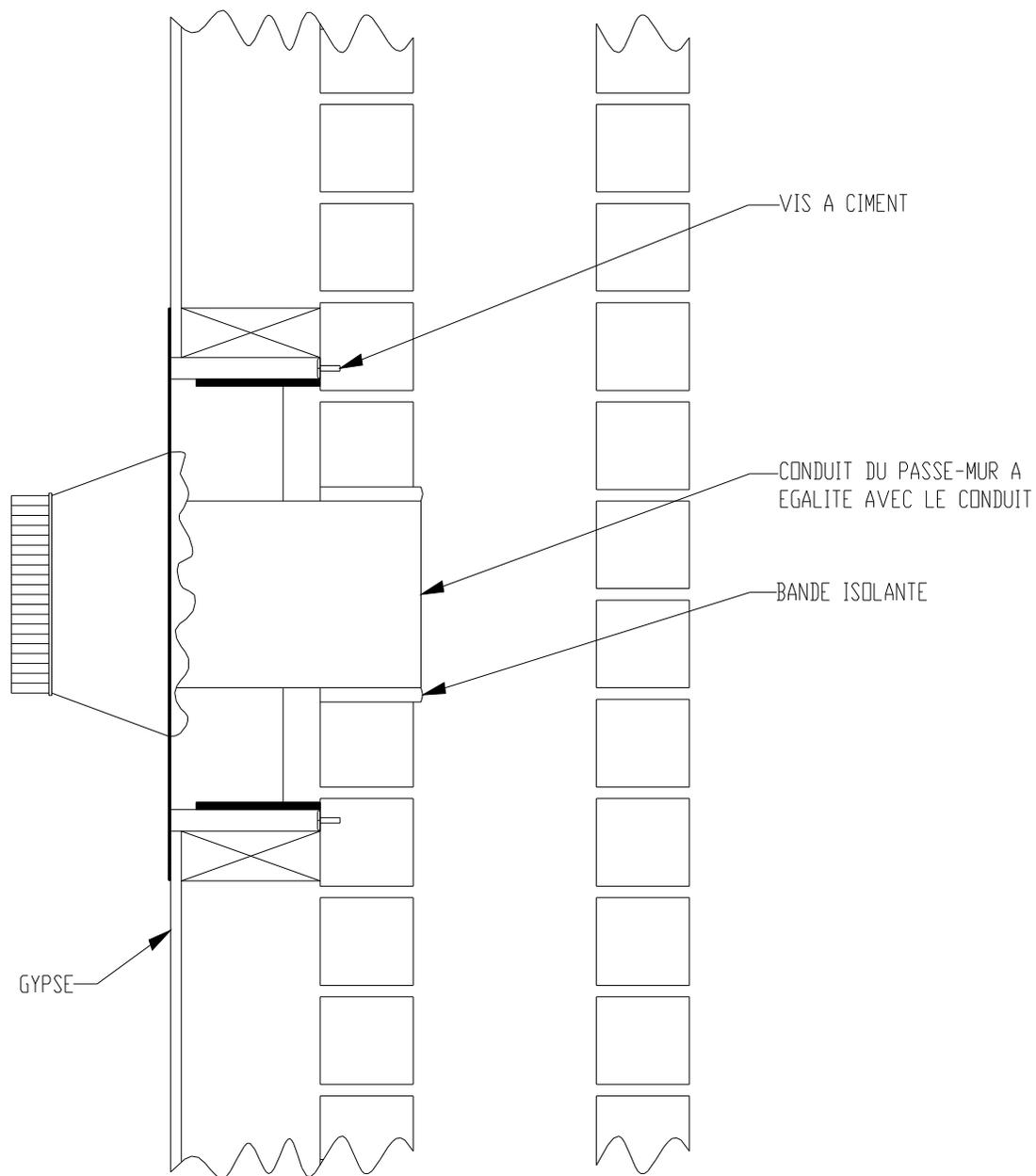
**FIGURE 2.2.2 (B) Passe-mur préfabriqué**
