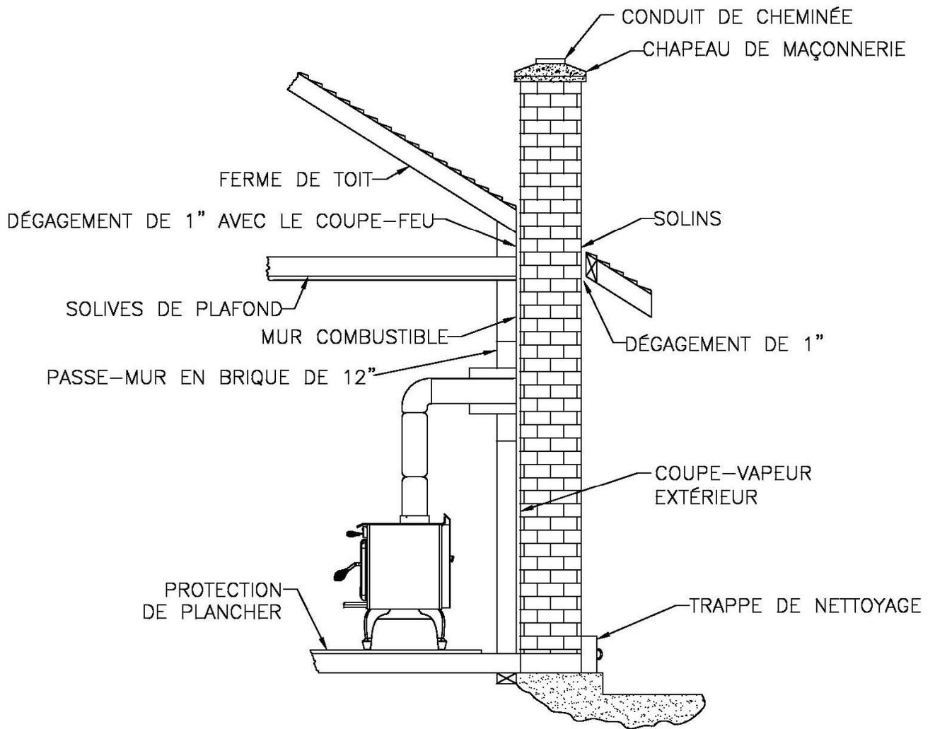
**FIGURE 2.2.2 (A) Installation à travers une cheminée de maçonnerie existante**
