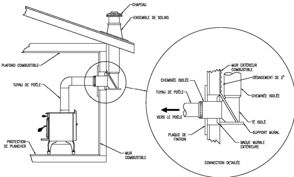
**FIGURE 2.2.1 (A) Installation typique à travers le mur**
